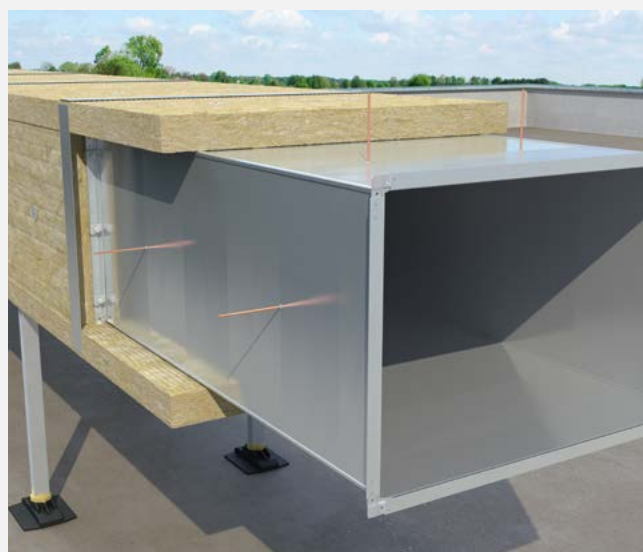
Układanie płyt KLIMASLAB wraz z mocowaniem szpilkami zgrzewanymi do blachy kanału.
