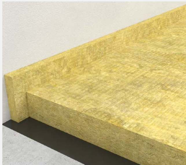
Układanie płyty STEPROCK BASE oraz paska RST.
