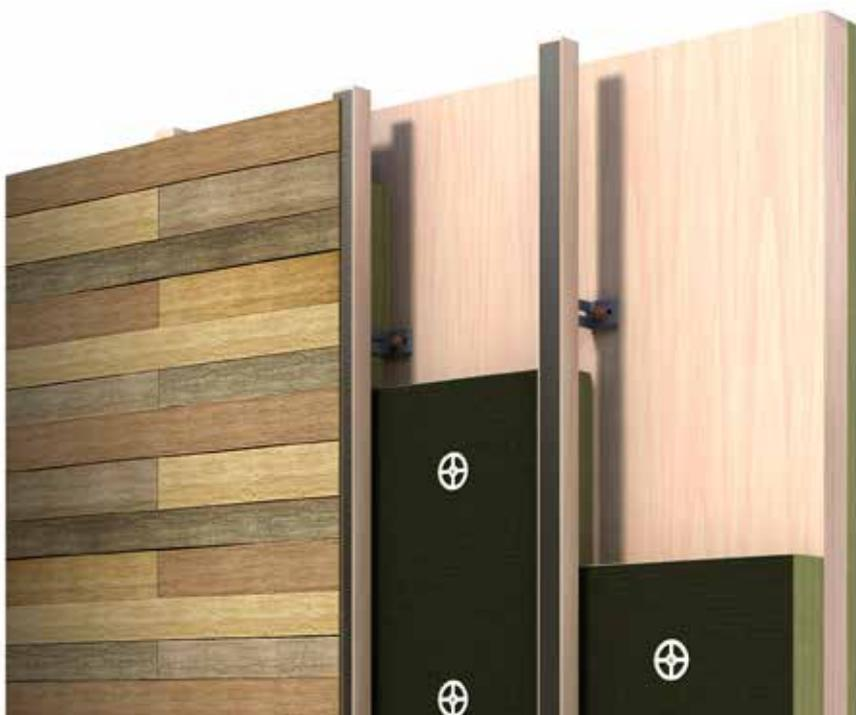
Il sistema di rivestimento a parete ventilata, di seguito analizzato, è composto da pannelli isolanti del tipo Fixrock 33 VF e dai pannelli di rivestimento in lana di roccia compressa Rockpanel dello spessore pari a 8 mm oppure 9 mm su supporto in legno costituito da pannelli in CLT (tipo X-Lam) dello spessore di 100 mm.
