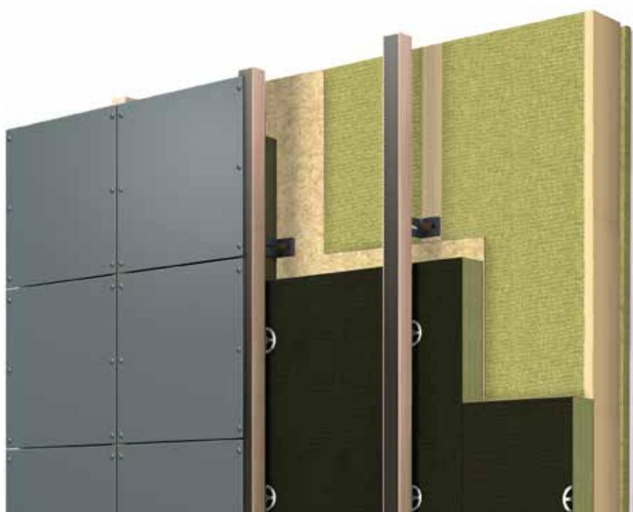
Il sistema di rivestimento a parete ventilata, di seguito analizzato, è composto da pannelli isolanti del tipo Fixrock 33 VF e dai pannelli di rivestimento in lana di roccia compressa Rockpanel dello spessore pari a 8 mm oppure 9 mm su supporto in legno (tipo Timber frame).
