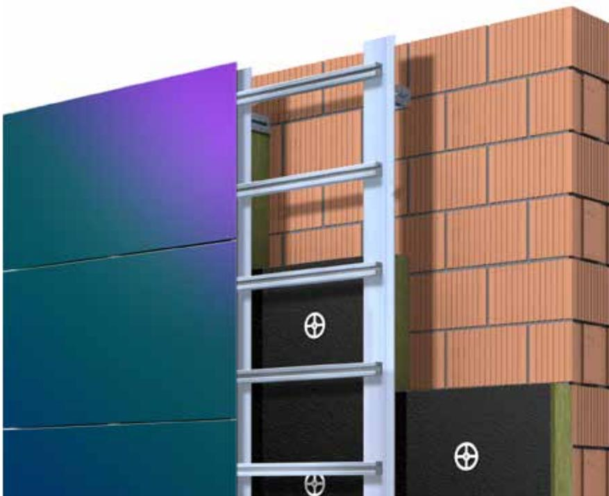
Il sistema di rivestimento a parete ventilata, che viene di seguito analizzato, è composto da pannelli isolanti del tipo Fixrock 33 VF e pannelli di rivestimento in lana di roccia compressa Rockpanel dello spessore pari a 11 mm su supporto murario costituito da tamponamenti in blocchi di laterizio alveolati dello spessore di 300 mm.
