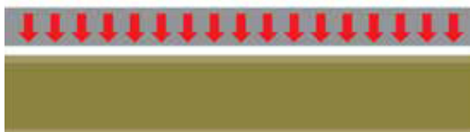
Carico distribuito ( \sigma_{10} ) - Norma UNI EN 826
