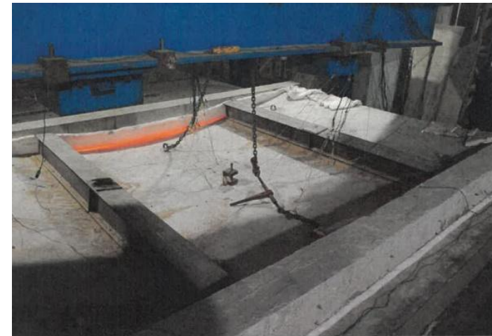
Fot. 5. Element próbny w 241 minucie badania - widok od strony nienagrzewanej
