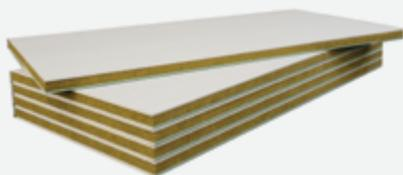
Panneau sandwich composé d'une âme isolante en laine de roche de forte densité (48 mm) collée de part et d'autre à une plaque de plâtre (standard et hydrofugée) ép.13 mm.
