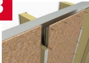
An der Innenseite der Fassade werden OSB-Platten auf die Stützen und U-Profile geschraubt. Die OSB-Platten sind die luftdichte Schicht des Systems.
