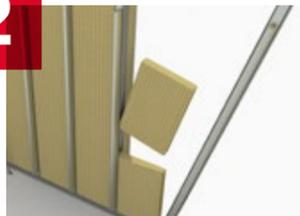
Die Zwischenräume zwischen den Stützen werden mit Rockzero Kerndämmung ausgefüllt und im Anschluss daran wird die Oberseite mit einem U-Profil abgeschlossen und mit einem Holz-Rähm versehen.
