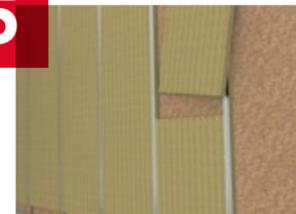
Vor die OSB-Platten an der Innenseite wird als dritte Dämmschicht die Innendämmung geklebt. Leitungen lassen sich in dieser Installationsebene problemlos und unsichtbar verlegen.
