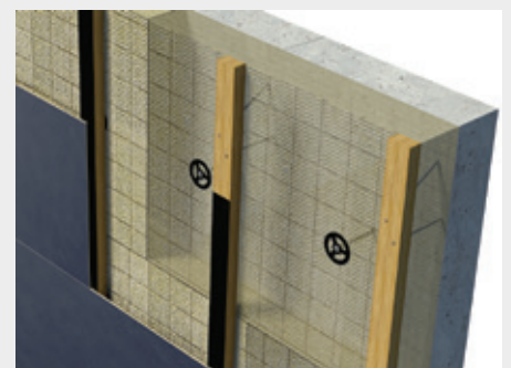
Thermisch geoptimaliseerde bevestigingswijze met afstandschroeven
