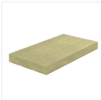
Panneau isolant à double densité avec une couche supérieure résistante à la pression. Les panneaux sont posés avec le côté long en direction horizontale sur la structure du toit, en commençant par la poutre de support en bas de la pente, puis en quinconce jusqu'à la faîtière.
