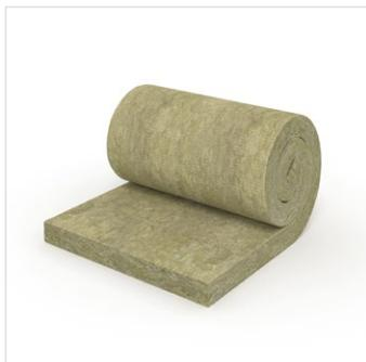
Panneau de laine de roche léger et résilient, fourni en rouleaux de 1000 mm de largeur, conçu pour être posé entre les chevrons ou les poutres avec des écarts fixes ou variables. Des bandes sont découpées dans le rouleau avec un excédent d'environ 5 mm en largeur.
