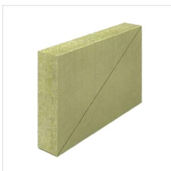
Panneau semi-rigide en laine de roche (environ 40 kg/m<sup>3</sup>), qui peut être installé entre des chevrons ou des poutres avec des espacements fixes ou variables. Le panneau isolant est coupé en deux triangles égaux en diagonale. En déplaçant les deux moitiés l'une par rapport à l'autre, la largeur du panneau change.
