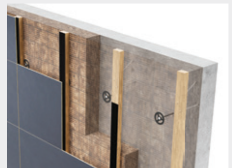
Méthode de fixation thermiquement optimisée avec vis d'écartement
