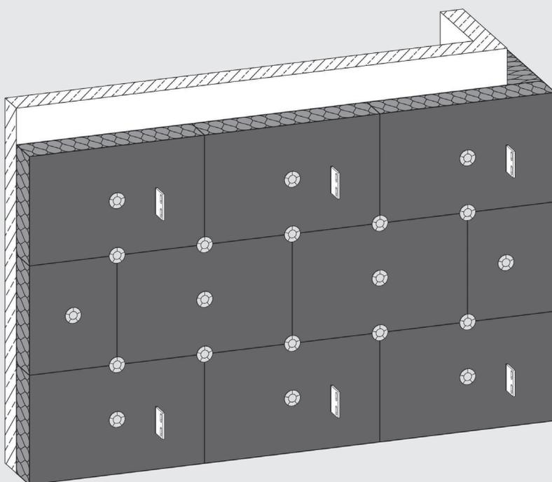
Nichtbrennbare Steinwolle-Dämmplatte\* mit einseitiger schwarzer Vlieskaschierung für die Dämmung von vorgehängten hinterlüfteten Fassaden. Freie Bewitterung bis zu 3 Monaten möglich.
