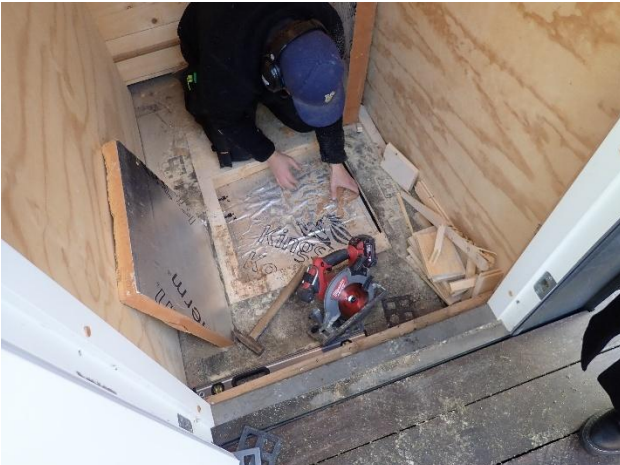
Bilde A.13 Uttak av prøve nr 683 og 684. Plata lå rett under de første prøvene som ble tatt ut.
