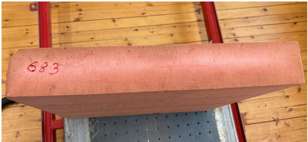
Bilde 4.1 Prøve 683 klar for prøving av termisk konduktivitet etter justering av tykkelse.
