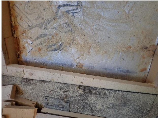
Bilde A.8 Isolasjonsprøve 681 klar til uttak.
