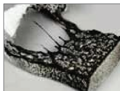
Figur 64: Ekspanderet polystyren (EPS) efter 1/2 minut.
