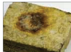
Figur 67: ROCKWOOL stenuld efter 30 minutter.
