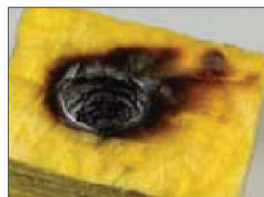
Figur 66: Mineraluld på glasbasis efter 7 minutter.
