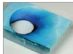
Figur 65: Ekstruderet polystyren (XPS), brandhæmmende, efter 1 min.
