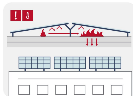
Reflexionen av strålningsvärme kan främja spridningen av en brand under solpanelerna.
