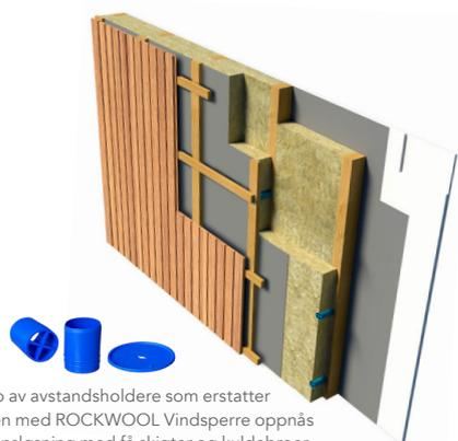
Platene festes ved hjelp av avstandsholdere som erstatter utlekting. Brukt sammen med ROCKWOOL Vindsperre oppnås en helt vindtett isolasjonsløsning med få skjøter og kuldebroer.
