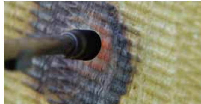
Steinwolle im Brandversuch
